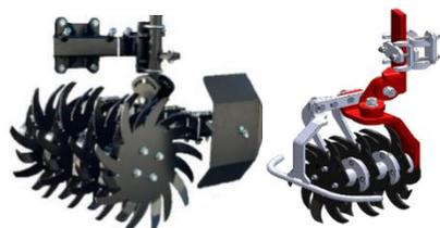
Пальцевый дисковый культиватор для садов оснащён перед пропашной звездой дисковым модулем для предварительного рыхления почвы.
