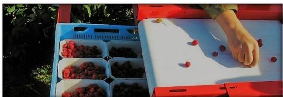
2. ЭФФЕКТИВНАЯ СИСТЕМА ДЛЯ ОЧИСТКИ ФРУКТОВ: Комбайн оснащен гидравлически управляемой системой высокой очистки (для удаления листьев и загрязнений при приемке собранных фруктов, имеющей регулируемую скорость до 1000 об/мин.
