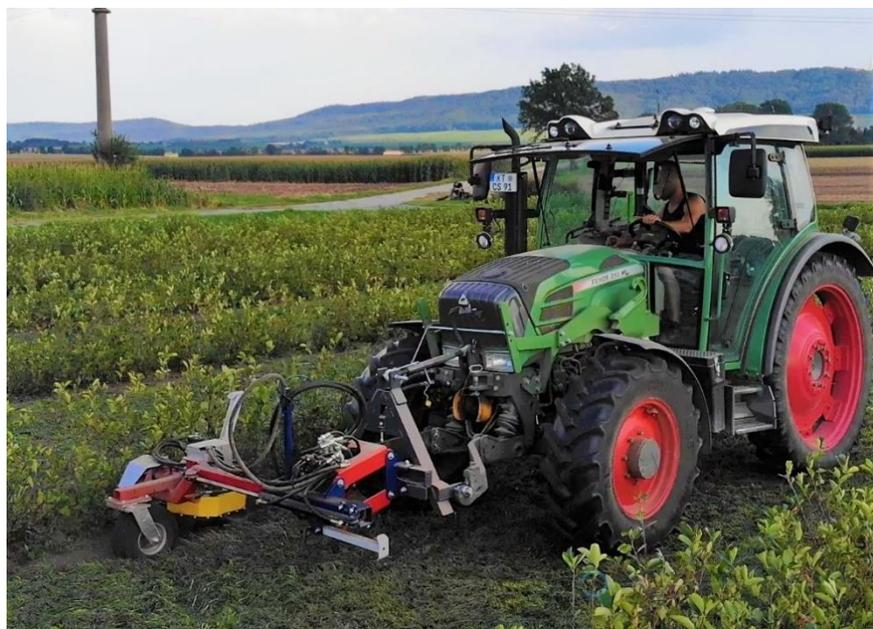
✓ La bineuse automatique LUCY est contrôlée au moyen d'une console électrique située dans la cabine du tracteur
